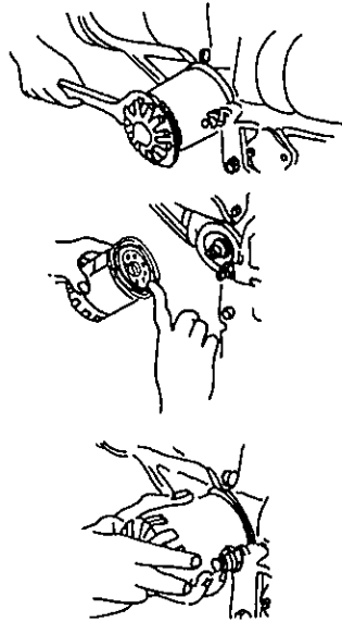
オイルフィルタ交換
