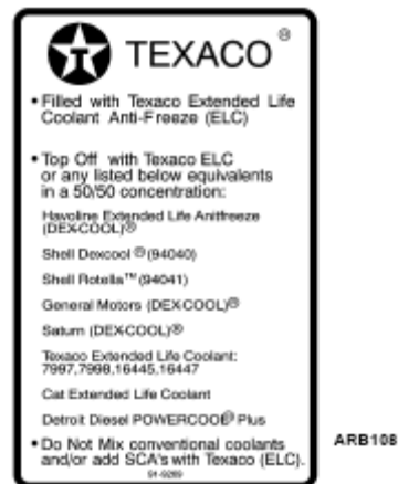
図 2: (ELC)長寿命冷却液ネームプレート (ELC を操作方法しているユニットのエキエスパンションタンクに貼ってあります)
