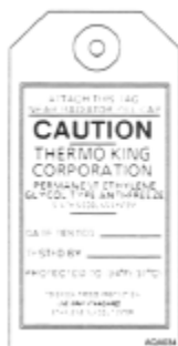
図 1: 不凍液に関する注意 (ラジエターキャップの近くに貼ってあります)
