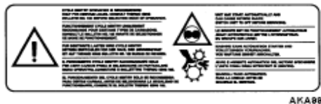
図 4: 自動発進警告(機種によって表示位置は異なります。ステッカは、手や衣類がからまると重大な人身事故につながる危険性の有る駆動部品のある位置に貼ってあります。)
